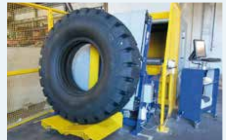
Kontrolle mittels Shearografie
